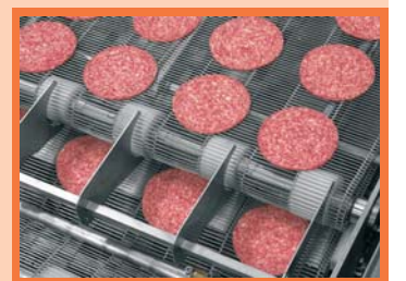
Fase previa de atemperamiento y secado rápido a temperatura y humedad controladas
