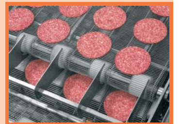
Fase previa de atemperamiento y secado rápido a temperatura y humedad controladas
